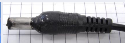
発熱して変形したDCプラグ
