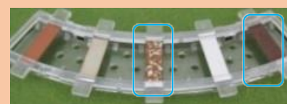
鉄ニッケル合金、鉄の変色＝二酸化硫黄の影響
