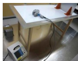
静電気印加設備
