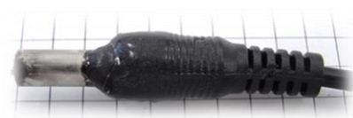
発熱して変形したDCプラグ (赤リントラブル)
