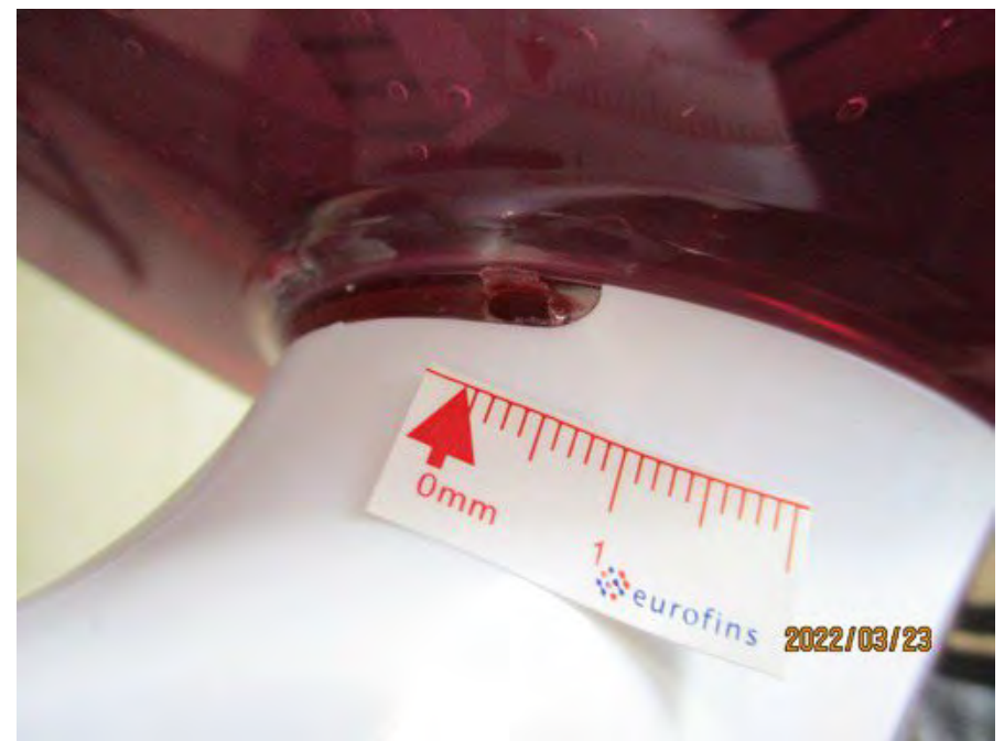
1 - D1 Broken mark -major 1
